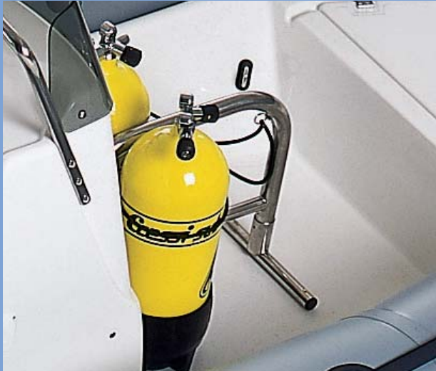
Z2157 Halterung für 4 Tauchflaschen (Cadet 400 Rib)
